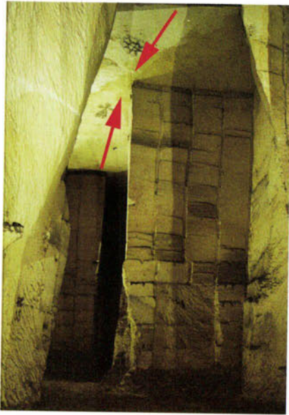
FIGUUR 2 ▲ Indien ontginningen elkaar raken ontstaan de zogenaamde 'doorbraken'. Caestertgroeve. Hier met plafondmarkeringen. De pijlen geven de graafrichting aan (foto: J. Silvertant).
